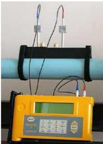
2) Ультразвуковой толщиномер позволит определять фактическую толщину трубопроводов, что даст возможность оперативно выявлять “слабые” места в тепловых сетях для дальнейшего ремонта или замены. Рекомендуются отечественные производители – Темп УТ-1 или 2. Стоимость – 30 т.р.
